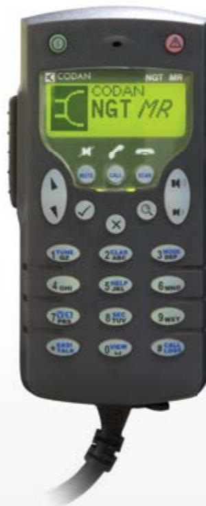
O aparelho inovador do Transceptor NGT™ MR contém todas as funções de controle de rádio e de monitoramento
